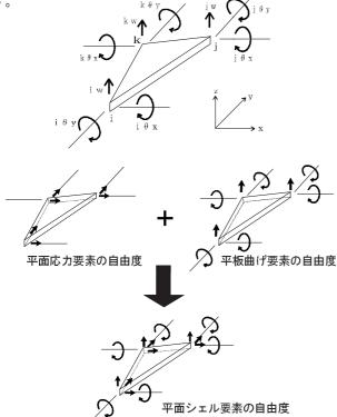
上の図は基本要素である三角形要素(要素分割した最小の要素)の節点の自由度を、図化したものです。「平面応力要素」はX,Y方向、「平板曲げ要素」はZ方向、 $\theta \times (\theta \times (\theta + 1))$ の自由度があるため、『平面シェル要素』の自由度はX,Y,Z方向と $\theta \times (\theta + 1)$ になります。
